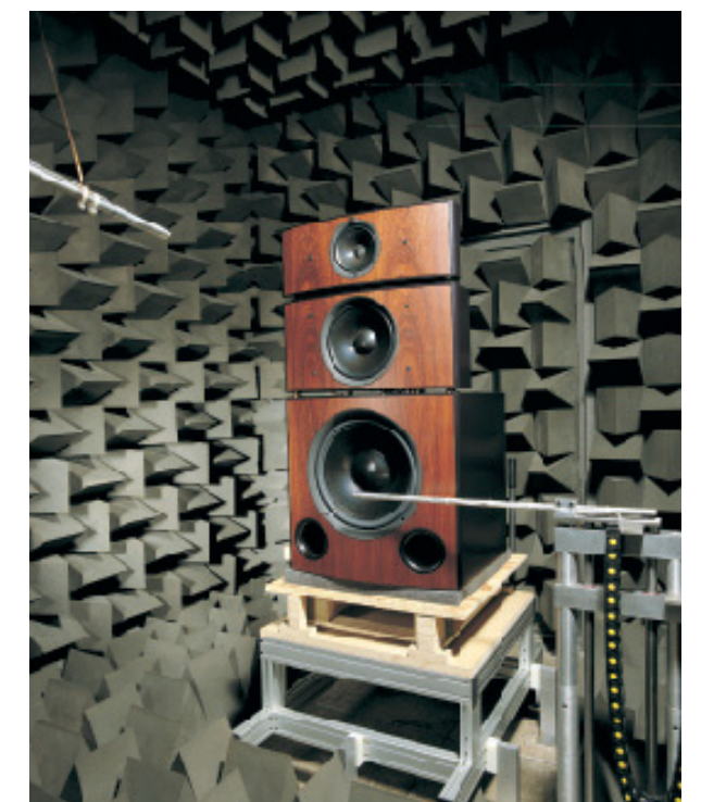
pomiar parametrów kolumn
